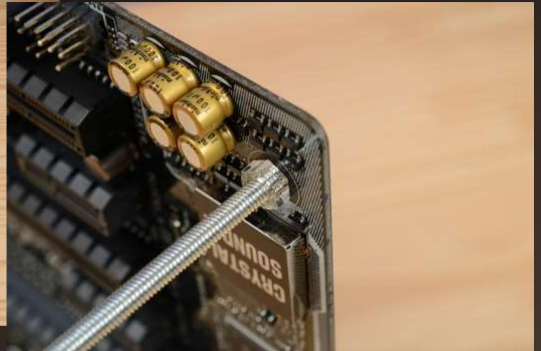
別パーツの作業。これは「土台」。M 4 のボルトと樹脂製のナットを使って、ASUSのZ97-PROに 9 本の脚を取り付ける
